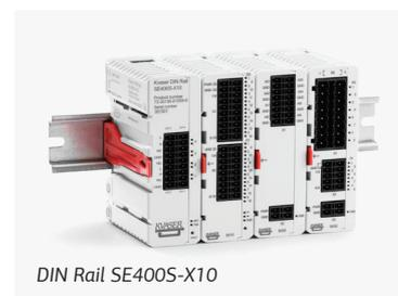
Mario Hoppe, RAC的营销和销售经理：“虽然Wi-Fi和蓝牙在许多测试现场中传输数据的速度足够快，但是长距离传输涉及到建筑物布局和环境限制，使它们在此处不适用。测试证明DIN-Rail SE400S-X10是一种多功能的替代产品，可编程，通过以太网连接到四路CAN/CAN FD通道，并支持所有主要的CAN协议类型。通过以太网连接，将许多DIN导轨模块分配到相应的测试台上变得非常便捷。”
